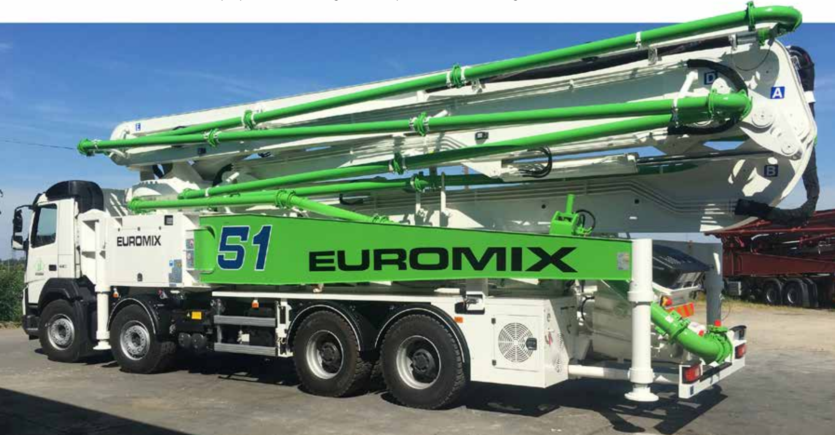
De Aut 51 pomp op vierassige vrachtwagen met een werkhoogte tot 51 m mag in België op de autoweg.
